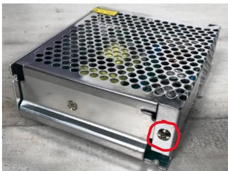
On peut maintenant mettre l'alimentation dans la partie basse du boîtier et la fixer avec la vis retirée et les 2 vis fournies.
