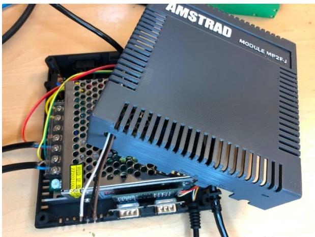
Puis on les passera par le trou dans lequel la prise Jack sera mise. Quand la prise sera montée, la partie supérieure ne pourra plus être complètement séparée du reste de la boîte.
