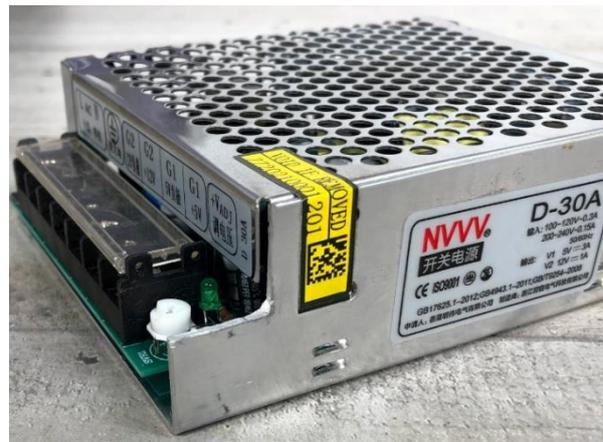
Une dernière chose avant de la monter est de retirer la vis à l'arrière de l'alimentation. C'est celle qui se trouve sur le bord de l'alimentation
