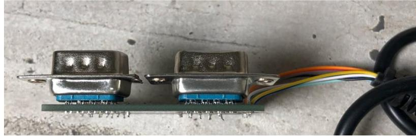
Une fois l'une des 2 prises coupée, les insérer dans le PCB en appuyant bien. Elles doivent tenir fermement et être bien alignées, c'est important pour que ce montage s'insère dans la partie inférieure.
